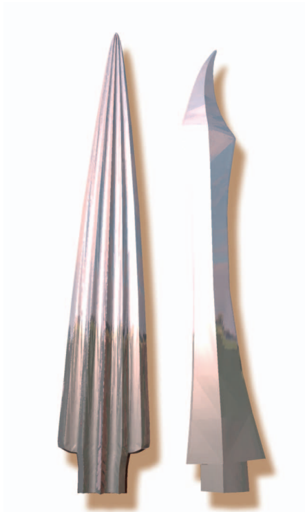
Abbildung 1: Breite Klingen werden im Ansatz gestaucht, damit Sie auch auf schmale Griffe passen.
